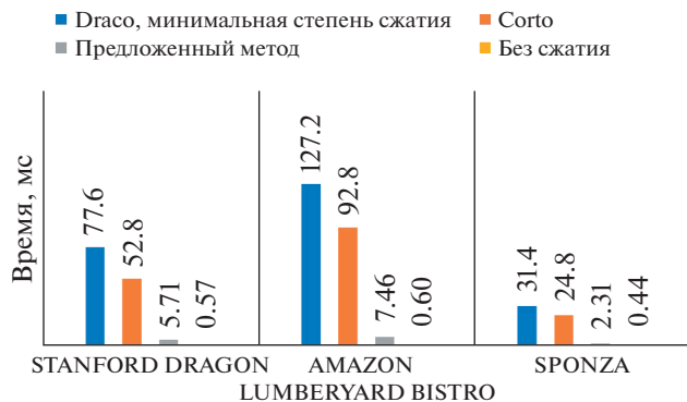
Рис. 8. Сравнение времени декомпрессии. Проводилось на GPU RTX 2070 Mobile для предложенного метода и версии без сжатия и на Intel Core I7 10750H для остальных методов, так как ими не поддерживается декомпрессия на GPU.
