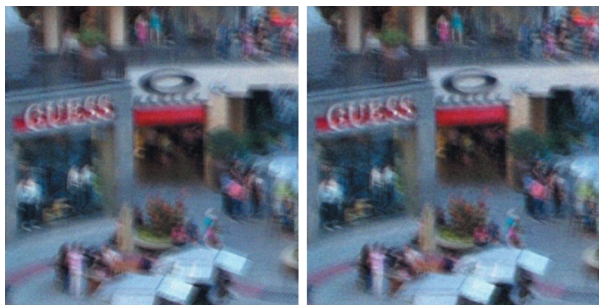
Рис. 2. Слева – размытое изображение с сильным шумом, справа – результат восстановления с помощью DeblurGAN.
