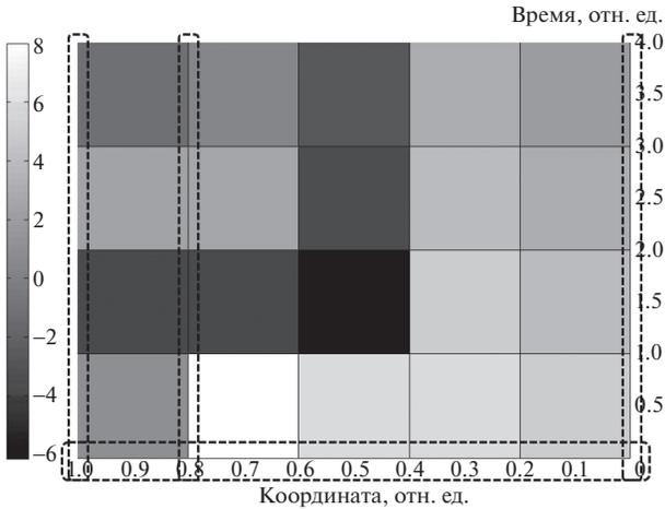
Рис. 4. Изменение температуры в образце в течение 4 временных шагов (пунктиром выделено множество начальных данных).
