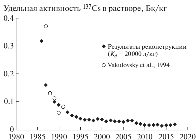
Рис. 8. Реконструированный временной ход растворенного ^{137}\text{Cs} в р. Упы, предполагая K_d равным 20 000 л/кг, в сравнении с результатами измерений 1987–1991 гг. [33].
