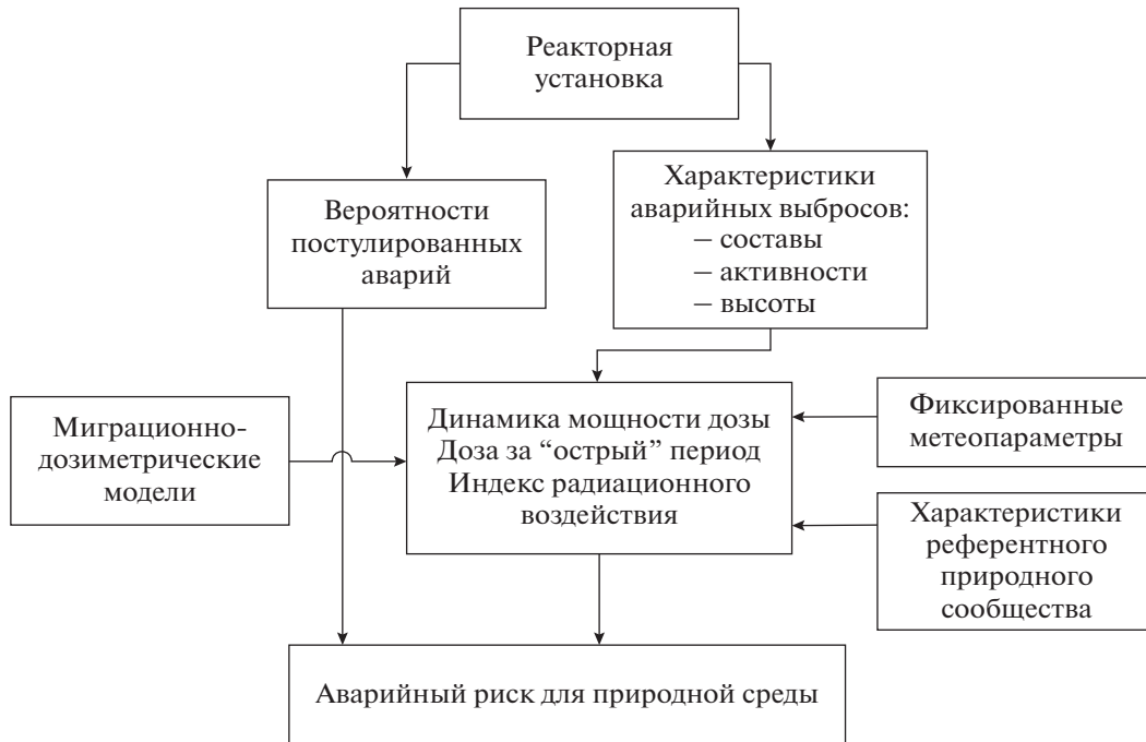
Рис 1. Общая схема консервативной оценки аварийного риска воздействия реакторной установки на природную среду.
