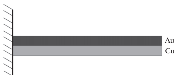
Рис. 12. Материалы, из которых изготовлен рассматриваемый кантилевер.
