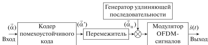
Рис. 1. Схема алгоритма формирования сигнальных конструкций на основе OFDM-сигналов.
