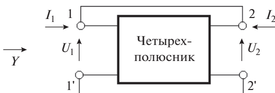
Рис. 4. Петлевое соединение, преобразующее четырехполюсник в двухполюсник.
