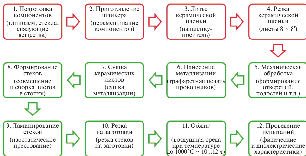
Рис. 1. Технология изготовления интегральных структур на основе ЛТСС-керамики.
