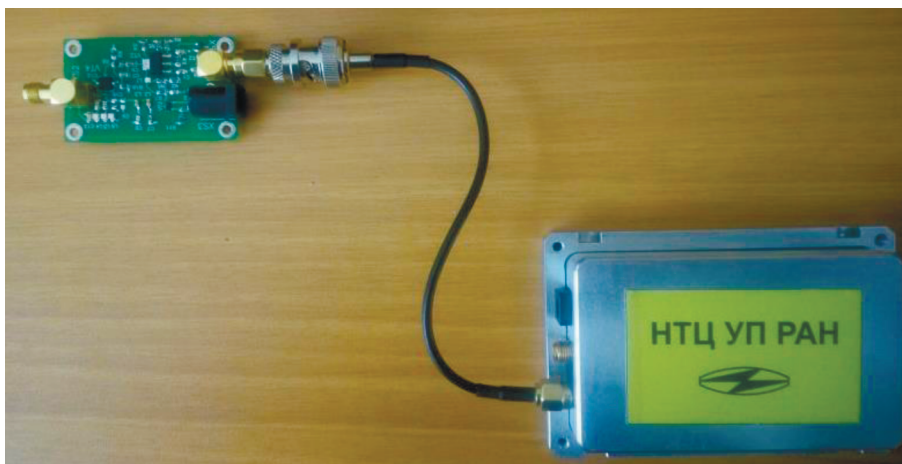
Рис. 3. Внешний вид макета ВЧ-усилителя и синтезатора частоты.
