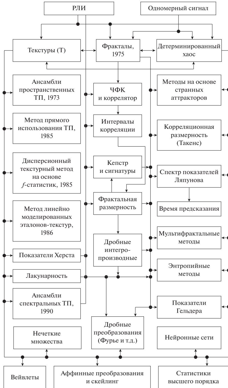
Рис. 5. Топологические признаки и новые методы обнаружения малококонтрастных объектов на фоне интенсивных помех, ТП – текстурные признаки, ЧФК – частотная функция когерентности, РЛИ – радиолокационное изображение.
