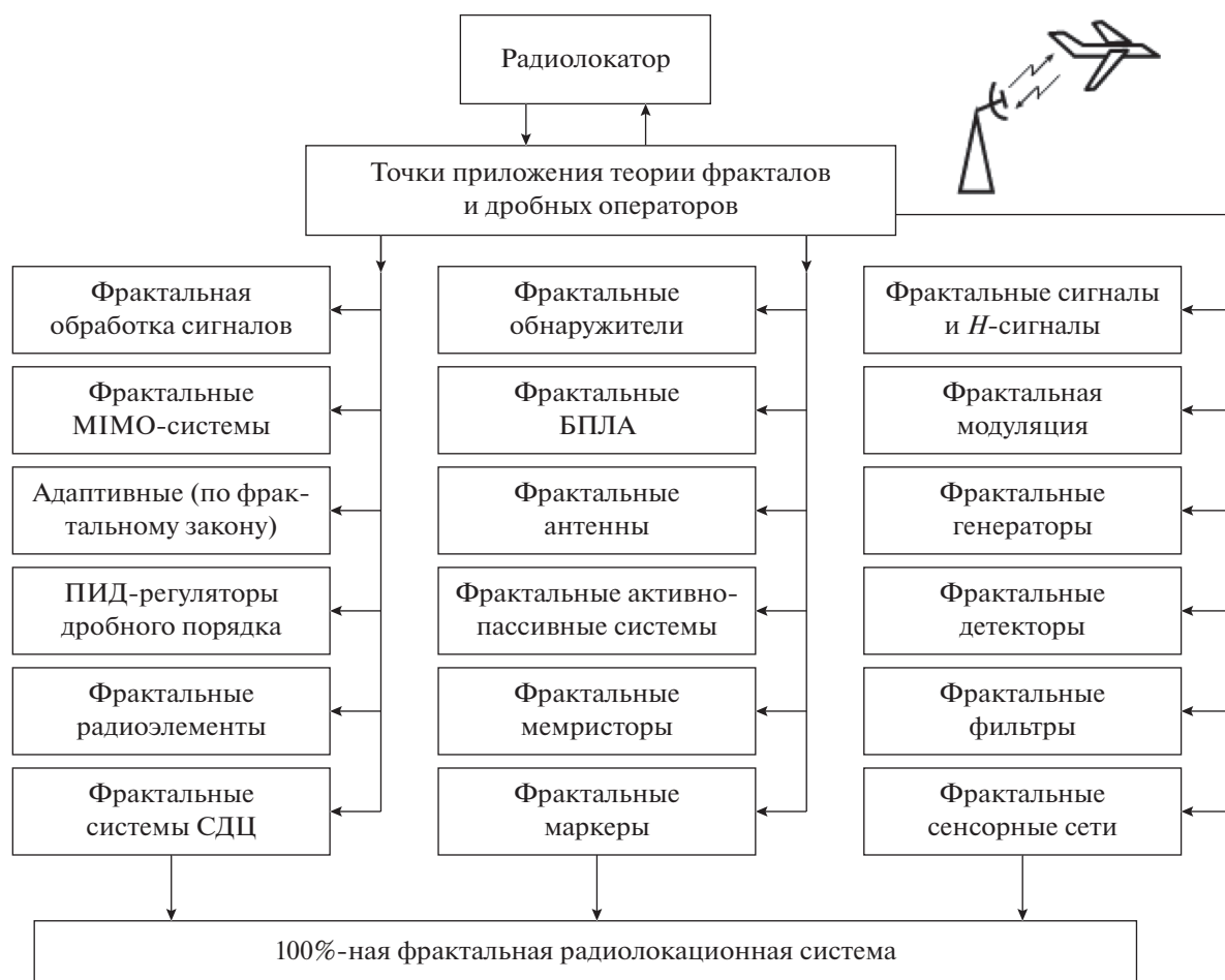
Рис. 7. Точки приложения фракталов, скейлинга и дробных операторов в классическом радиолокаторе с целью перехода к фрактальной радиолокационной системе; БПЛА – беспилотный летательный аппарат, СДЦ – селекция движущихся целей, ПИД-регулятор – пропорционально интегрально-дифференцирующий регулятор.
