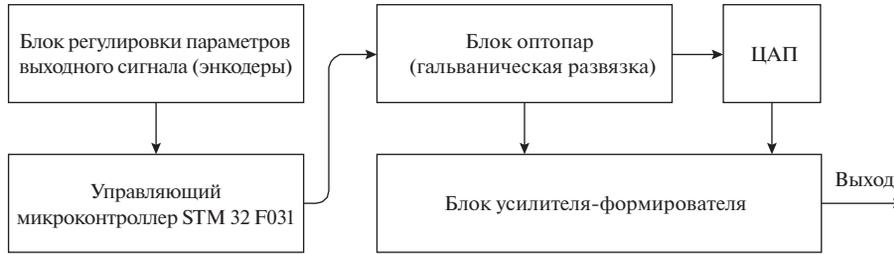
Рис. 2. Структурная схема разрабатываемого устройства.
