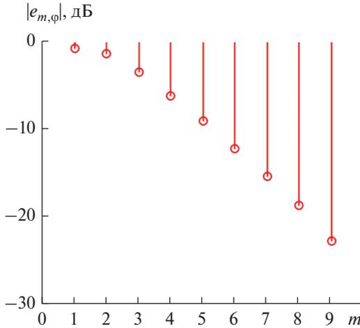
Рис. 1. Спектр поля излучения вращающегося заряда в плоскости вращения.
