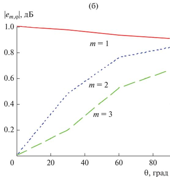
Рис. 3. Зависимость амплитуд меридиональных (а) и азимутальных (б) составляющих гармоник спектра от угла наблюдения  $\theta$ .
