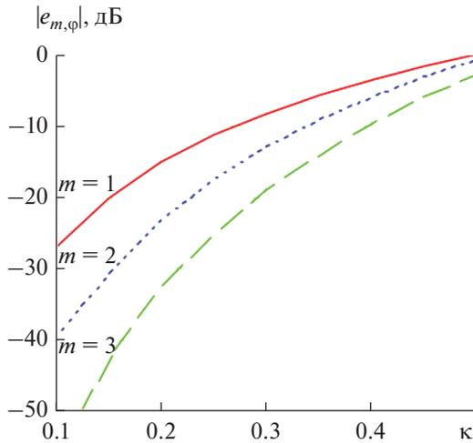
Рис. 2. Зависимость амплитуд гармоник спектра от относительной скорости движения заряда κ.
