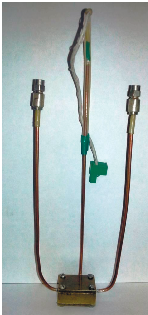
Рис. 3. Корпус ВТСП-резонатора с коаксиальными выводами для подключения измерителя КСВН и генератора напряжения треугольной формы.
