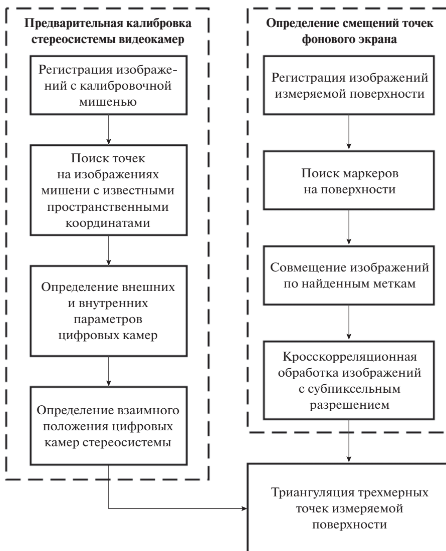
Рис. 4. Блок-схема алгоритма обработки изображений для восстановления трехмерной поверхности.
