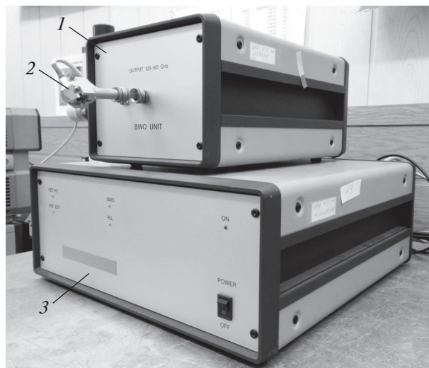
Рис. 1. Источник ТГц-излучения на основе ЛОВ: 1 – блок ЛОВ, 2 – выходной умножитель частоты 120...160 ГГц, 3 – блок питания для вспомогательной электроники.
