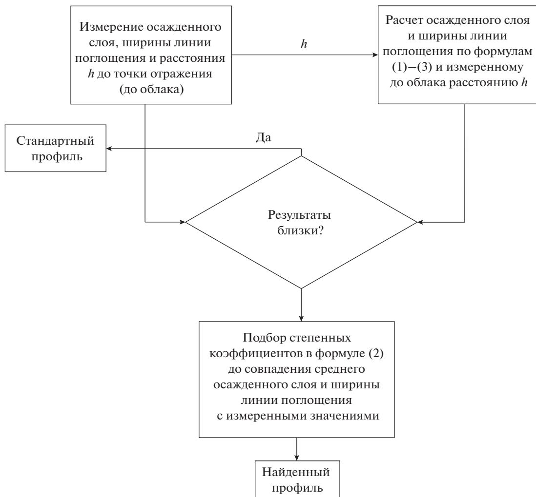
Рис. 2. Упрощенный алгоритм определения вертикального профиля распределения концентрации метана на разной высоте.
