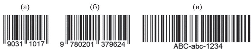
Рис. 1. Коды символики EAN-8 (а), EAN-13 (б) и EAN-128 (в).
