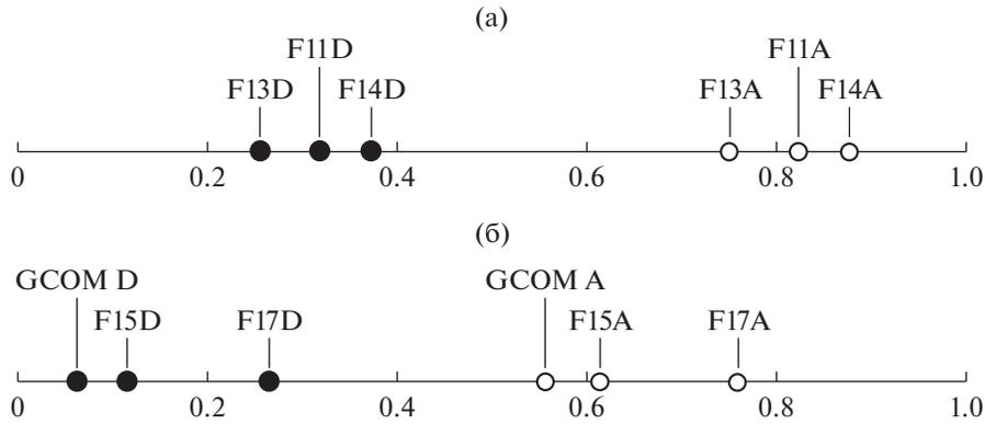
**Рис. 1.** Время пересечения экватора (в долях суток) спутниками F11, F13, F14 в 1999 г. (а) и спутниками F15, F17, GCOM в 2017 г. (б) на восходящих (А) и нисходящих (D) витках (время полета к районам зарождения ТУ Bret и Katia от экватора (6–7 мин) не учитывается; внесены поправки на зависимость времени пересечения экватора от сроков эксплуатации спутников к моменту съемок ураганов).
