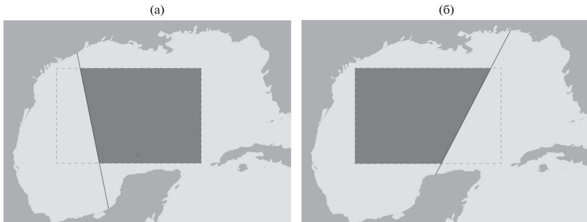
**Рис. 2.** Слепые (незатемненные) и видимые (затемненные) зоны Мексиканского залива в области интересов при обзоре спутником F13 (16 августа 1999 г.) на восходящем витке (а) и спутником F15 (5 сентября 2017 г.) на нисходящем витке (б); штриховая линия – область интересов, сплошная – трассы спутников.
