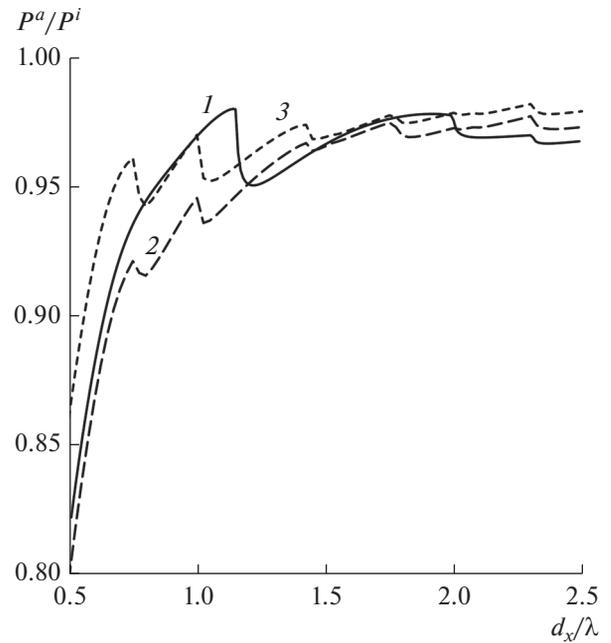
**Рис. 3.** Эффективность поглощения для структуры черных дыр с гексагональной сеткой, облучаемой  $TE$ - и  $TM$ -волнами под углом  $\theta = 0$  (1) и  $TE$ - (2) и  $TM$ -волнами (3) под углом  $\theta = 30^\circ$  в плоскости  $\varphi = 90^\circ$ , в зависимости от периода  $d_x$  при  $a = d_x/2$ ,  $a_1/a = 0.5$ ,  $\beta = 2.5$  и  $\epsilon_s = 1$ .
