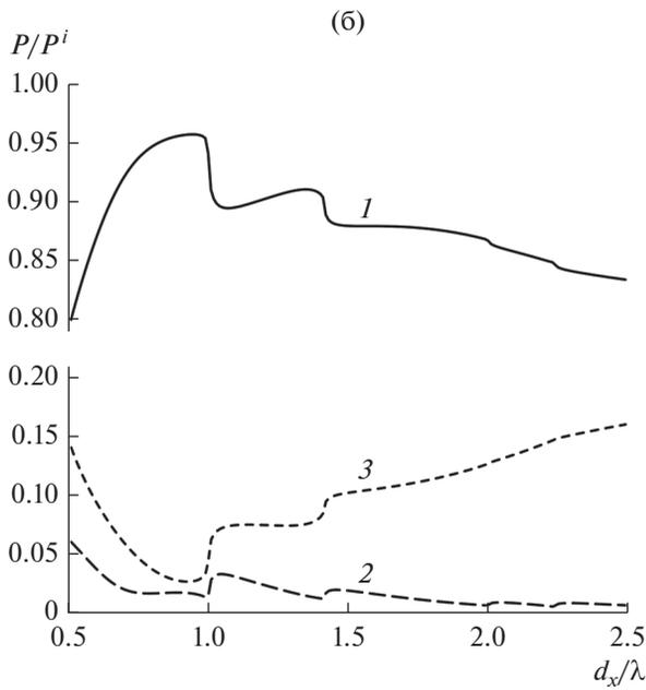
**Рис. 2.** Эффективность поглощения (1), а также нормированные отраженная (2) и прошедшая (3) мощности для структуры черных дыр с гексагональной (а) и с квадратной (б) сеткой в зависимости от периода  $d_x$  при  $a = d_x/2$ ,  $a_1/a = 0.5$ ,  $\beta = 2.5 \epsilon_s = 1$  и  $\theta = 0$ .
