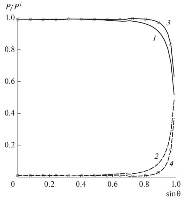
**Рис. 6.** Эффективность поглощения  $P^a$  ( $TE$  (1) и  $TM$  (2)) и нормированная отраженная мощность  $P^r$  ( $TE$  (3) и  $TM$  (4)) для гексагональной структуры черных дыр в зависимости от угла падения  $\theta$  в плоскости  $\varphi = 0^\circ$  при  $a_1/a = 0.5$  и  $\beta = 2.5$ .
