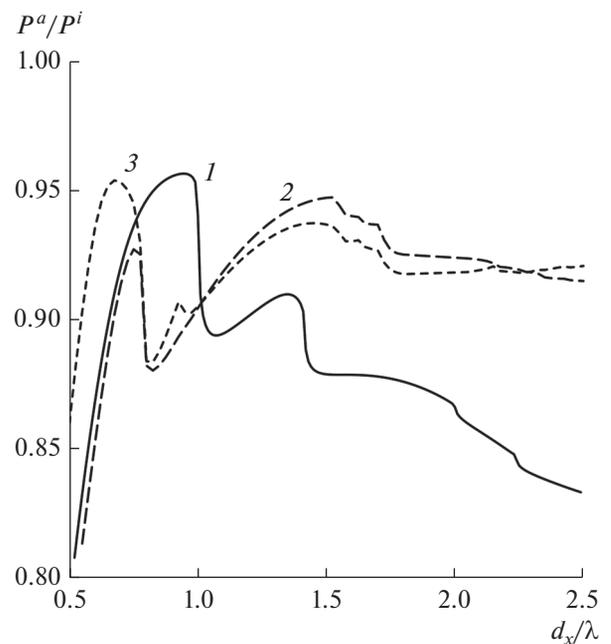
**Рис. 4.** Эффективность поглощения для структуры черных дыр с квадратной сеткой, облучаемой  $TE$ - и  $TM$ -волнами под углом  $\theta = 0$  (1) и  $TE$ - (2) и  $TM$ -волнами (3) под углом  $\theta = 30^\circ$  в плоскости  $\varphi = 45^\circ$ , в зависимости от периода  $d_x$  при  $a = d_x/2$ ,  $a_1/a = 0.5$ ,  $\beta = 2.5$  и  $\epsilon_s = 1$ .
