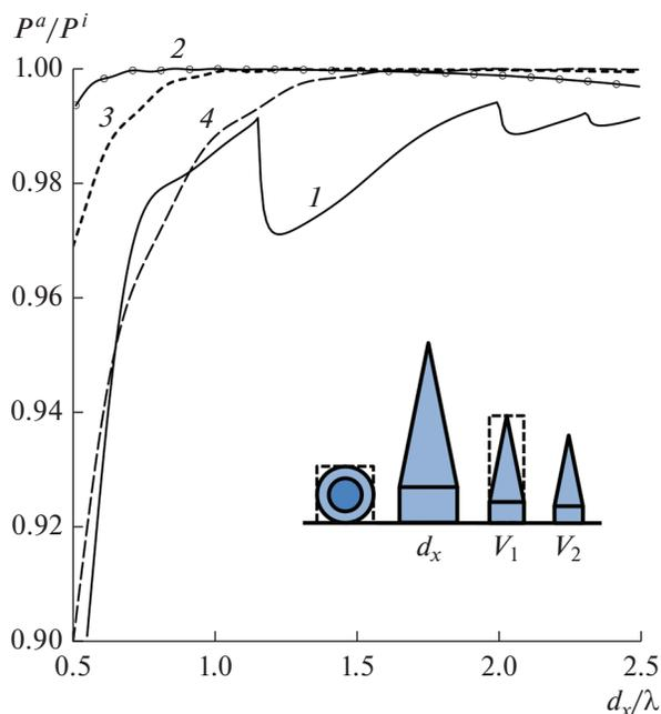
**Рис. 7.** Эффективность поглощения в зависимости от периода сетки при  $\theta = 0^\circ$  для черных дыр в гексагональной сетке и пирамидальных поглотителей в квадратной сетке: 1 – черные дыры, 2 – пирамиды с тем же периодом  $d_x$ , 3 – пирамиды с тем же объемом ячейки  $V_1$ , 4 – пирамиды того же объема  $V_2$ , расположенные на экране.
