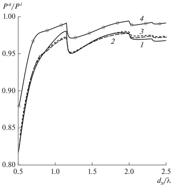
**Рис. 5.** Влияние диэлектрической проницаемости подложки и экрана на эффективность поглощения структуры с гексагональной сеткой при  $a = d_x/2$ ,  $a_1/a = 0.5$  и  $\beta = 2.5$ ;  $\epsilon_s = 1$  (1), 2 (2), 4 (3), структура на экране (кривая 4).
