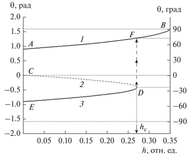
Рис. 5. Зависимости равновесного значения полярного угла намагниченности  $\theta$  от нормированного поля  $h$  при анизотропии второго и четвертого порядков; параметры:  $K_2 = -100$  отн. ед.;  $K_4 = 100$  отн. ед.
