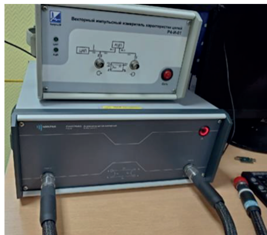
Рис. 4. Векторный анализатор электрических цепей “Панорама” Р4226.
