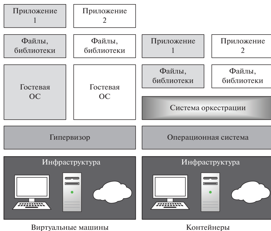
Рис. 1. Схема организации микросерверной архитектуры на основе виртуальных машин и контейнеров. ОС – операционная система.
