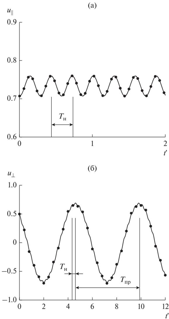
**Рис. 5.** Динамика продольной  $u_{\parallel} = M_{\parallel}/M_S$  (а) и поперечной  $u_{\perp} = M_{\perp}/M_S$  (б) компонент вектора намагниченности при  $\xi = 50$ ,  $r = 20$ : сплошные линии – аналитическое решение (12) и (19); символы – численное решение уравнений (3) и (4); начальные условия:  $\vartheta(0) = \varphi(0) = \pi/4$ ,  $\dot{\vartheta}(0) = \dot{\varphi}(0) = 0$ ,  $T_{пр} = 2\pi/\omega_{пр}$  – период прецессии.
