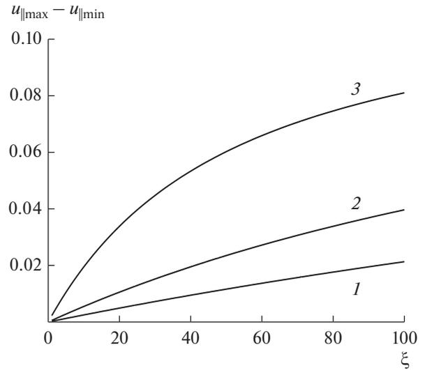
**Рис. 4.** Амплитуда нутаций в зависимости от величины поля  $\xi$  для различных значений обратного параметра инерции:  $r = 30$  (1), 20 (2), 10 (3); использованы следующие начальные условия:  $\vartheta(0) = 0.5$ ,  $\dot{\vartheta}(0) = \dot{\varphi}(0) = 0$ .
