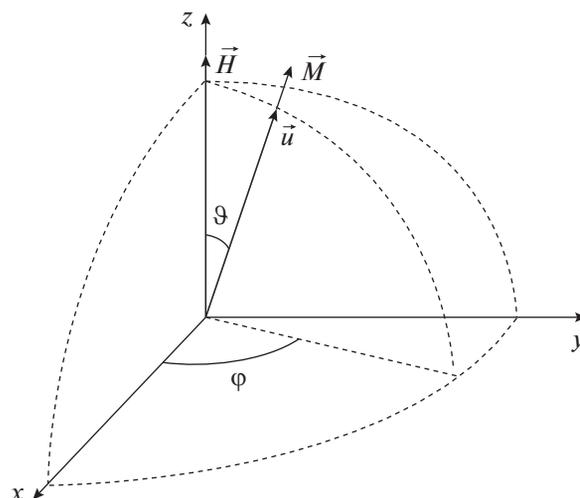
Рис. 1. Вектор намагниченности  $\vec{M}$ , вектор поля  $\vec{H}$ , полярный угол  $\vartheta$  и азимутальный угол  $\varphi$  в лабораторной системе координат.
