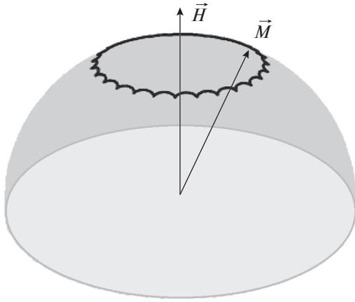
**Рис. 3.** Прецессия и нутация намагниченности  $\vec{M}$  в поле  $\vec{H}$  в отсутствие затухания, рассчитанные при  $r = 25$ ,  $\xi = 50$ ,  $\vartheta(0) = 0.5$ ,  $\dot{\vartheta}(0) = \dot{\varphi}(0) = 0$ .
