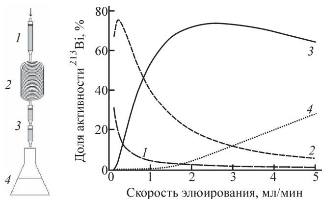
**Рис. 9.** Расчет распределения  $^{213}\text{Bi}$  между частями хроматографической системы в зависимости от скорости элюирования (скорость движения  $^{213}\text{Bi}$  в среде Actinide Resin равна 0, время элюирования 6 ч). 1 – колонка с  $^{225}\text{Ac}$  (объем смолы 0.5 мл), 2 – трубка для распада  $^{221}\text{Fr}$  (44 мл), 3 – колонки для концентрирования  $^{213}\text{Bi}$  (объем смолы в одной колонке 0.15 мл), 4 – элюат.
