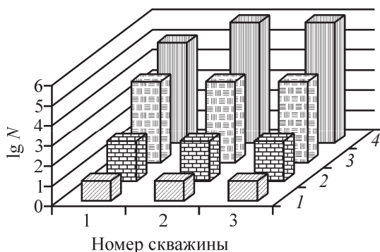
Рис. 1. Численность N анаэробных сульфат- (1), железо- (2) и нитратредуцирующих (3) бактерий и аэробных органотрофных бактерий (4) в пластовой воде, отобранной из трех наблюдательных скважин по контуру законсервированного хранилища Б-2 на территории СХК.
