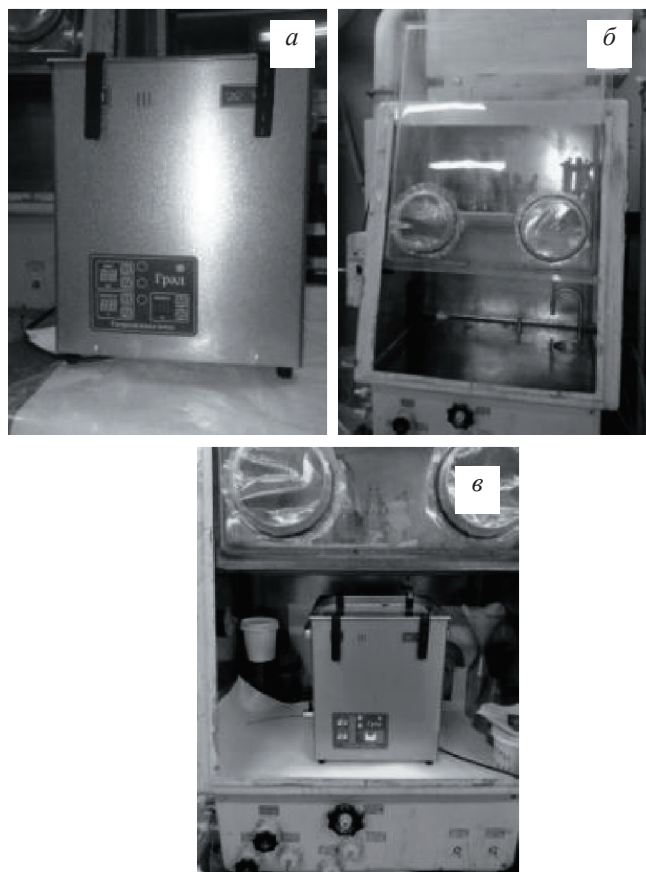
Рис. 1. Ультразвуковая ванна «Град» модели 180-35 (а), вытяжной шкаф с перчаточными проемами Ш1 НЖ 1980 (б), установка в сборе (в).
