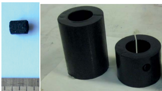
Рис. 1. Образцы облученного марки графита ГР-76 для испытаний на выщелачивание: тип 1 (слева), типы 2 и 3 (справа).
