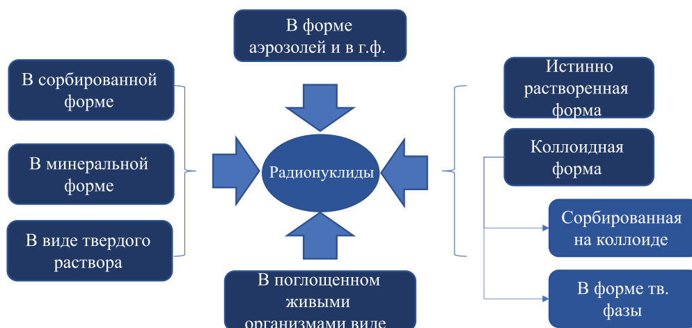
Рис. 1. Схема форм нахождения радионуклидов в водоемах.
