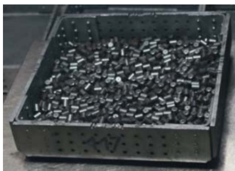
Рис. 9. Лодочка с таблетками РЕМИКС-топлива. АО «СХК» для снаряжения твэлов и сборки ТВС было отгружено 258 партий таблеток РЕМИКС-топлива, 257 из которых изготовлены с использованием шаровой вибромельницы МВ-0.01, 1 партия – с использованием смесителя АВС-150.
