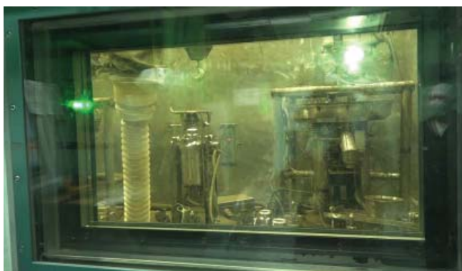
Рис. 6. Общий вид шаровой вибромельницы MB-0.01, размещенной в радиационно-защитной камере.
