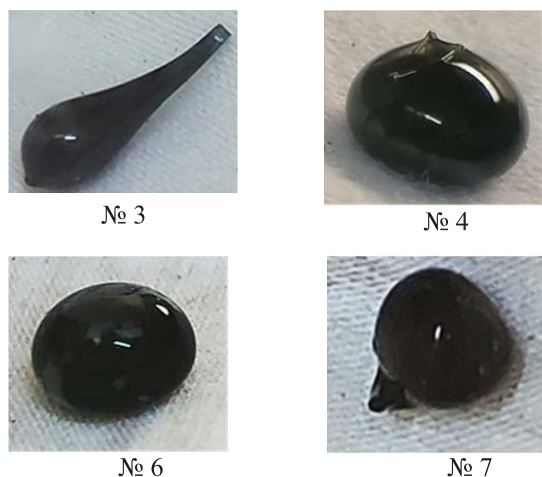
Рис. 4. Фото образцов после выщелачивания.
