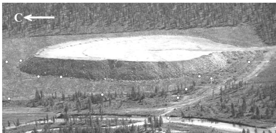
Рис. 1. Точки отбора водных проб на технологической площадке ПЯВ «Кристалл» размером 430 \times 330 м с глыбово-щебнистой насыпью, перекрывающей навал, возникший на эпицентре взрыва. На переднем плане – р. Улахан-Бысытта. Белыми кружками показаны точки отбора водных проб, проведенных нами (фотография с вертолета, автор фото В.Е. Захаров, 2007 г.).
