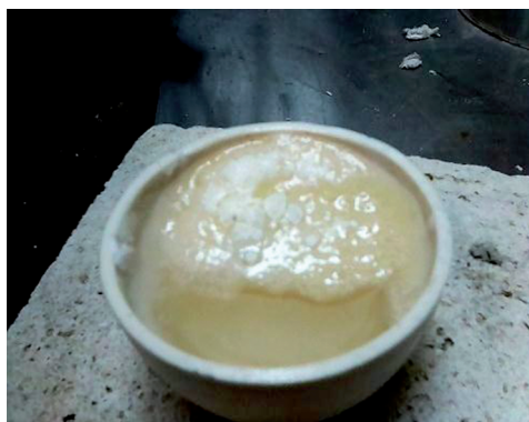
Рис. 6. Расплав, извлеченный из ячейки после циклической вольтамперометрии медно-алюминиевого сплава.
