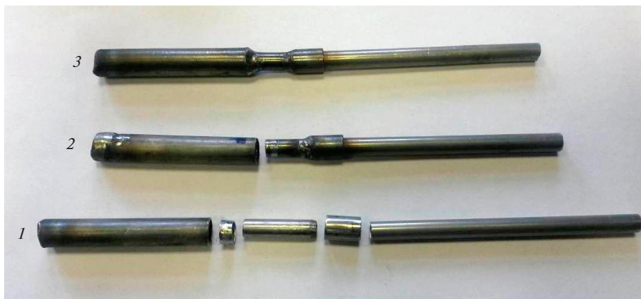
Рис. 2. Изготовление ампул из нержавеющей стали: 1 – составные части; 2 – ампула и переходник; 3 – ампула с приваренным переходником.
