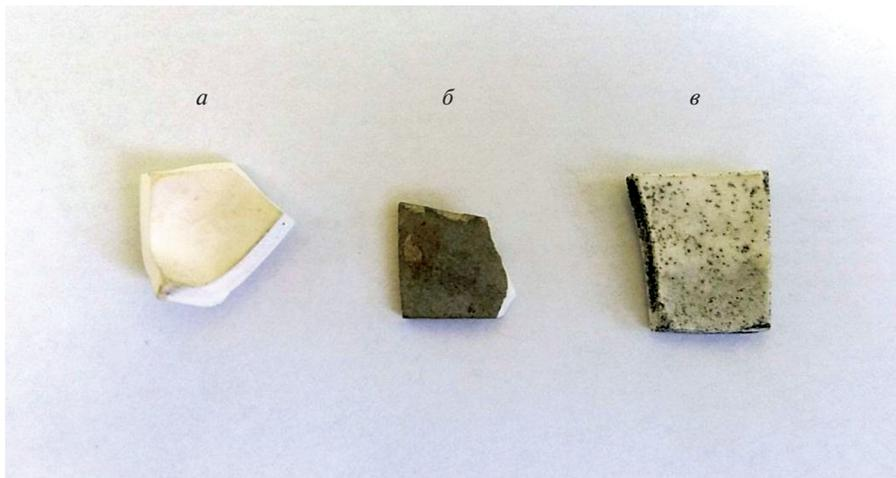
**Рис. 1.** Внешний вид образцов оксида магния: (а) до эксперимента; (б) после 8 ч выдержки в расплаве LiCl–KCl, с добавлением 1 мол. % NdCl<sub>3</sub>; (в) после 8 ч выдержки в расплаве LiCl–KCl, с добавлением 1 мол. % UCl<sub>3</sub> при 500°С.
