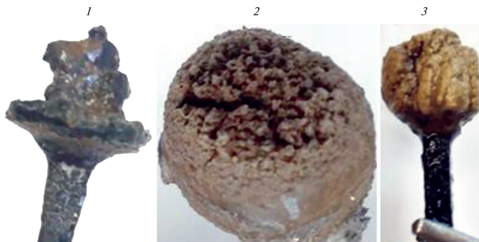
Рис. 7. Фотографии катодных осадков кремния, полученных при электролизе расплава KCl с 5 мас. % K_2SiF_6 при температуре 790^\circ C на стеклоглереде при катодном перенапряжении 0.25 (1), -0.15 (2) и -0.10 (3) В.
