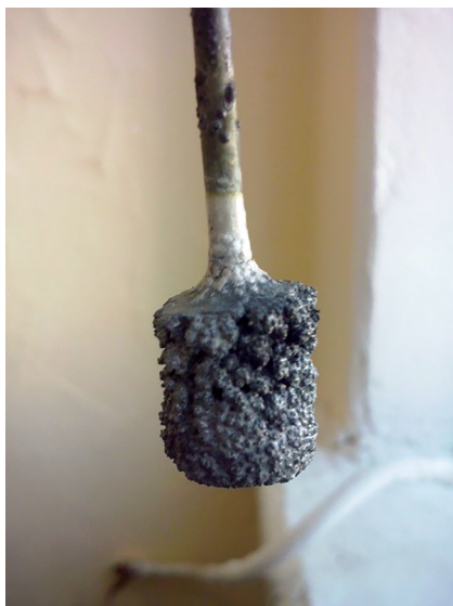
Рис. 2. Внешний вид карбидно-солевой “груши”, полученной электролизом расплава 45\text{K}_2\text{CO}_3\text{--}45\text{Na}_2\text{CO}_3\text{--}1\text{Li}_2\text{CO}_3\text{--}9\text{Li}_2\text{MoO}_4 (мол. %). T = 1023 К. Плотность тока – 2.0 \text{ A}/\text{cm}^2 .
