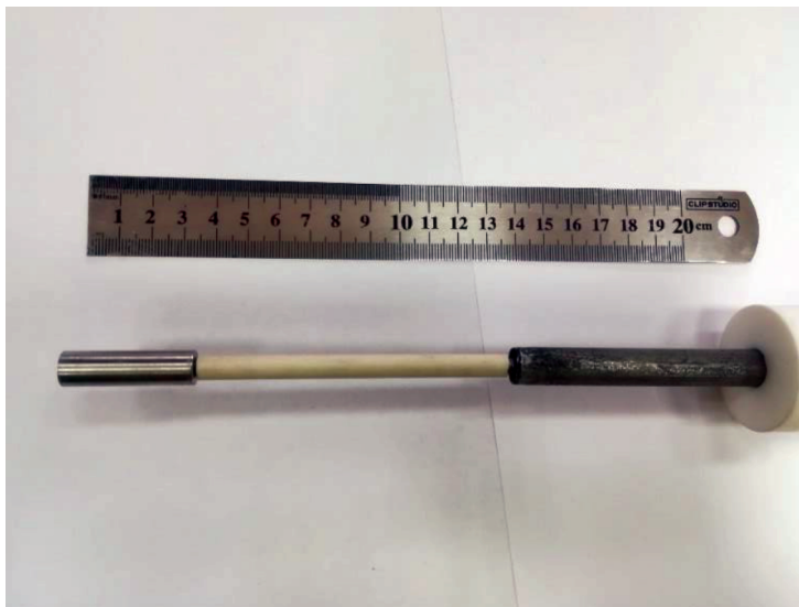
Рис. 4. Внешний вид катодной сборки (катод – слева).
