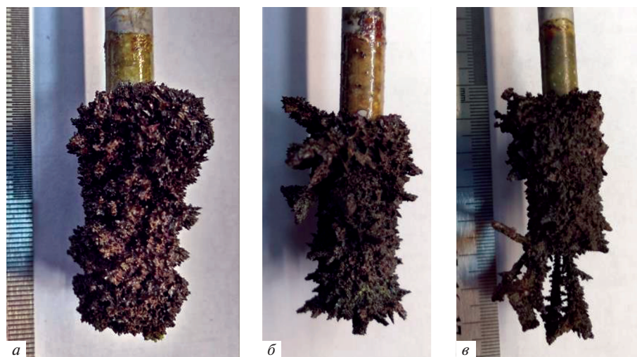
Рис. 6. Фотографии катодных осадков, полученных в ходе электрорафинирования U–Pd сплава с содержанием Pd в общей массе анода 1.58 мас. % при различных начальных катодных плотностях тока: a – 0.1; б – 0.2; в – 0.4 А/см 2 .
