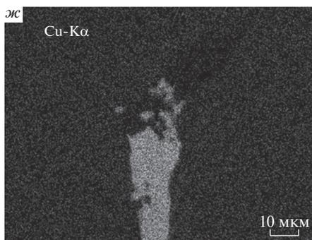
Рис. 8. Полиминеральный сросток (фаза X + пирротин II + халькопирит II + брейтгауптит + станнин II) и элементные карты микрографического сростка, обведенного рамкой на рис. а – изображение в поляризованном отраженном свете, б–ж – снимки в характеристическом рентгеновском излучении (б – Ag-L $\alpha$ ; в – Sb-L $\alpha$ ; г – Ni-K $\alpha$ ; д – Fe-K $\alpha$ ; е – Sn-L $\alpha$ ; ж – Cu-K $\alpha$ ).
