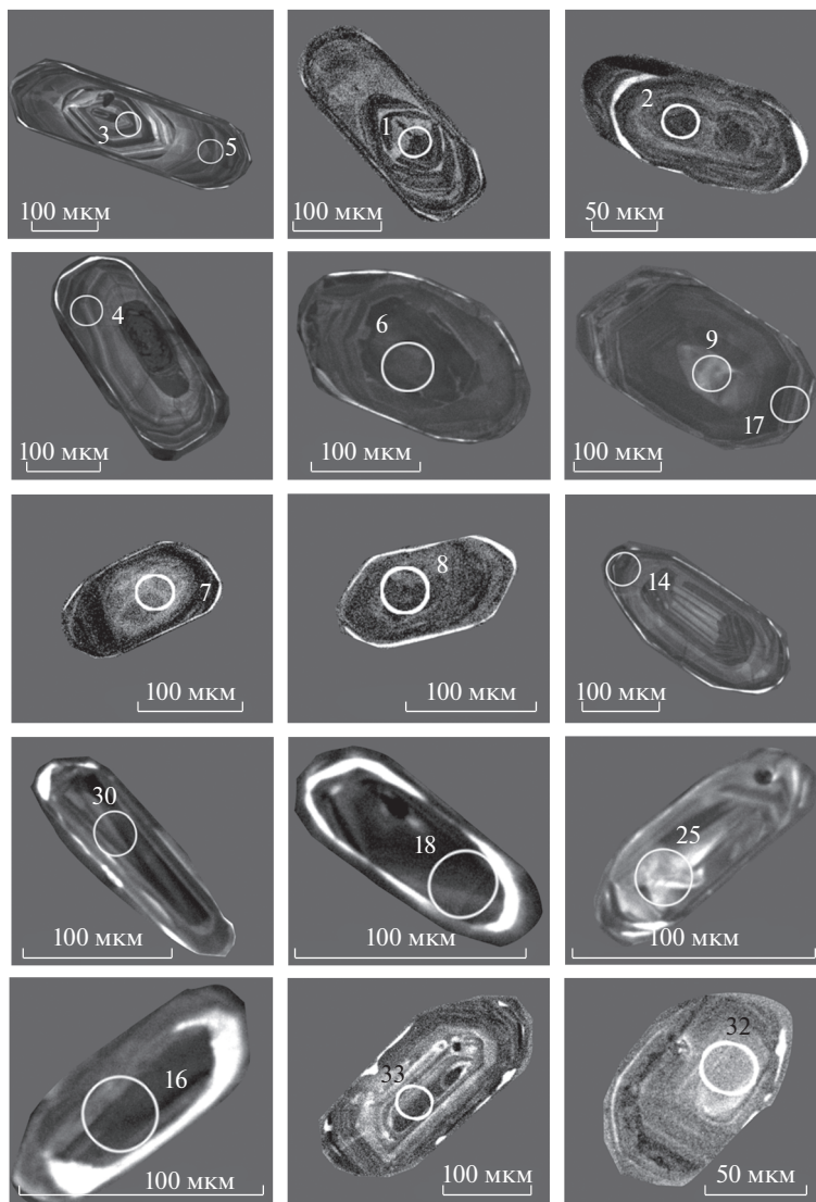
Рис. 3. Катодолуминесцентные фотографии циркона из гранитов. Кружки – области U-Pb изотопного анализа на поверхности кристалла, номера соответствуют номерам анализов в табл. 2.
