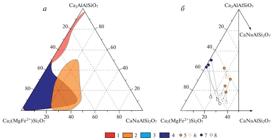
**Рис. 6.** Вариации состава минералов группы мелилита: *а* – мелилит из паралав и реликтоў ксенолитов осадочных карбонатно-силикатных пород; *б* – вариации состава зональных фенокристов. 1, 2 – Хамарин-Хурал-Хид; 3, 4 – Нилгинский комплекс; 5, 6 – Хамарин-Хурал-Хид; 7, 8 – Нилгинский комплекс. Стрелками на диаграмме (*б*) показано изменение состава от центральной к краевой зонам фенокристов.
