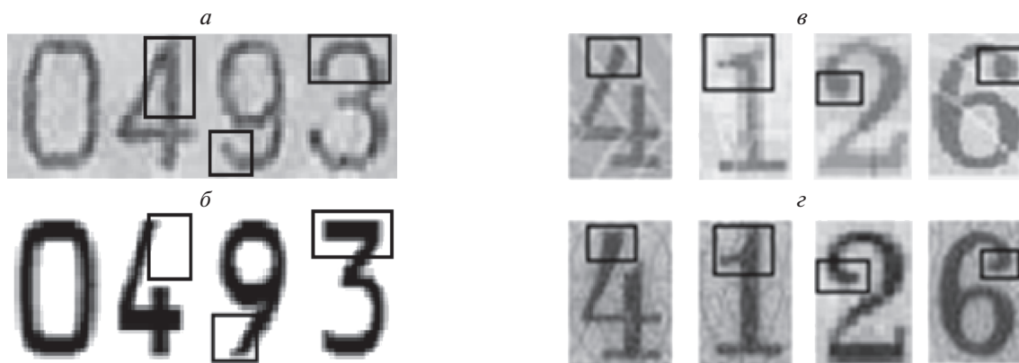
Рис. 6. Примеры изображений символов сфабрикованной — а и подлинной — б машиносчитываемой зоны документа, изображения цифр зоны номера сфабрикованного — в и подлинного — г паспорта гражданина РФ (цит. по Chernyshova et al., 2018).
