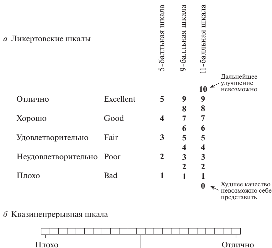
Рис. 9. Шкалы, используемые для оценки впечатлений испытуемых (ITU-R P.910, 1999) а – ликертовские балльные, б – квазинепрерывная.
