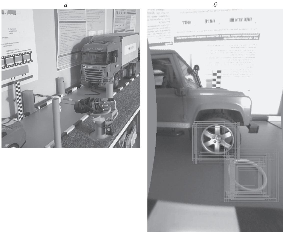
Рис. 13. а – общий вид полнофункционального макета АКТС; б – кадр проезда модели автомобиля с помещенным тестовым объектом.
