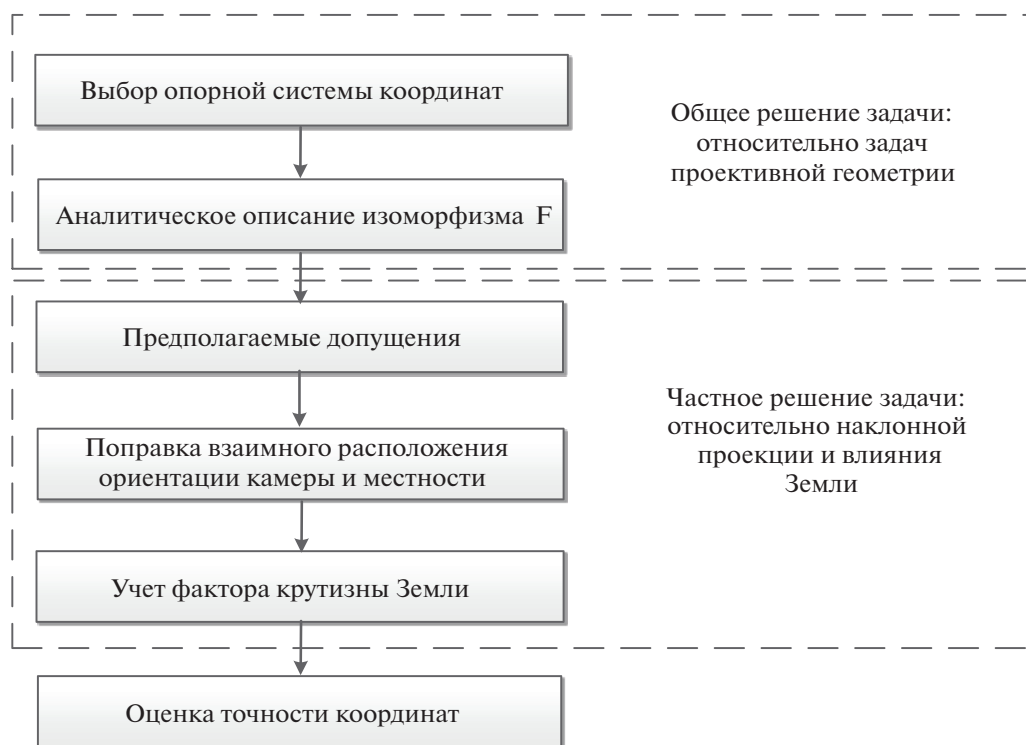
Рис. 2. Последовательность шагов по определению точности координат.
