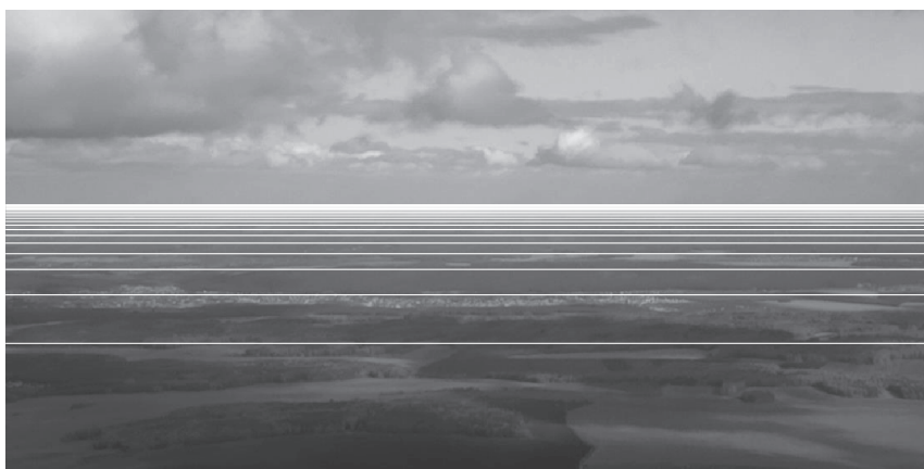
Рис. 12. Точность фотограмметрических измерений подстилающей поверхности на примере земной поверхности (фокусное расстояние f = 0.05 м; высота полета h = 550 м; угол наклона камеры \alpha = 83^\circ ).
