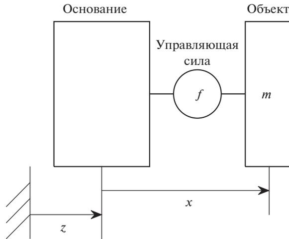
Рис. 1. Модель противоударной изоляции объекта на подвижном основании
