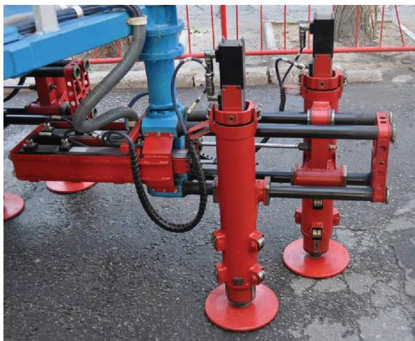
Рис. 3. Двигатель шагающей машины “Ортоног”
