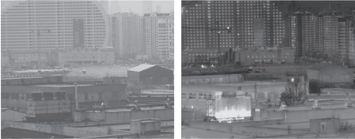
Рис. 5. Пример входных разносектральных изображений: слева – ТВ-изображение, справа – ИК-изображение (3–5 мкм)
