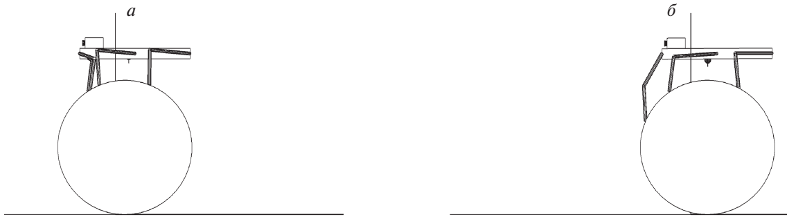
Рис. 24. Начало спуска с цилиндра (а), процесс спуска (б)
