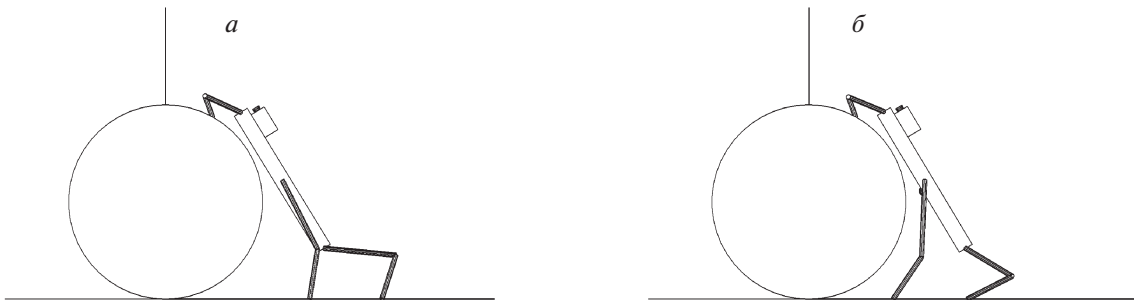
Рис. 19. Поворот корпуса завершён (а), задние и средние ноги переставлены (б)
