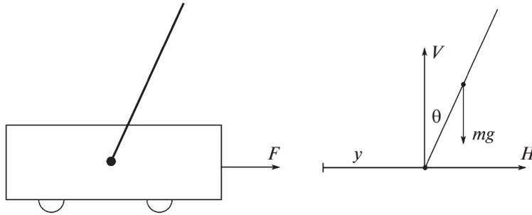
Рис. 2. Механическая система тележка–маятник
